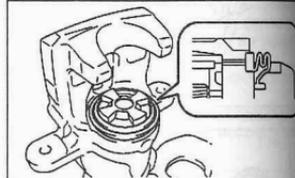
3. С помощью отвертки снимите манжету поршня.
